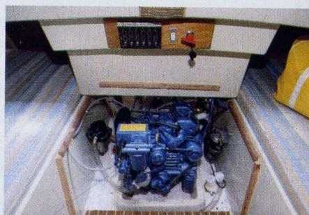
*Il 21 by Zuanelli da noi provato era equipaggiato da un motore ausiliario entrobordo diesel da 10 HP. L'ubicazione del motore sotto la scaletta di accesso, permette la massima ispezionabilità in caso di necessità.*
